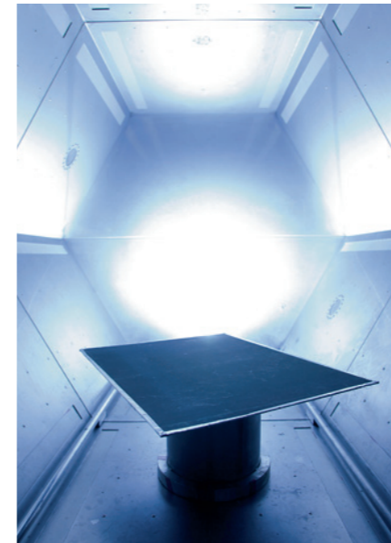
Wirkungsvolle Wellen aus der Wabe: In dem riesigen Mikrowellenofen lassen sich selbst große Platten aus CFK-Material effizient und ungestört stählen.
