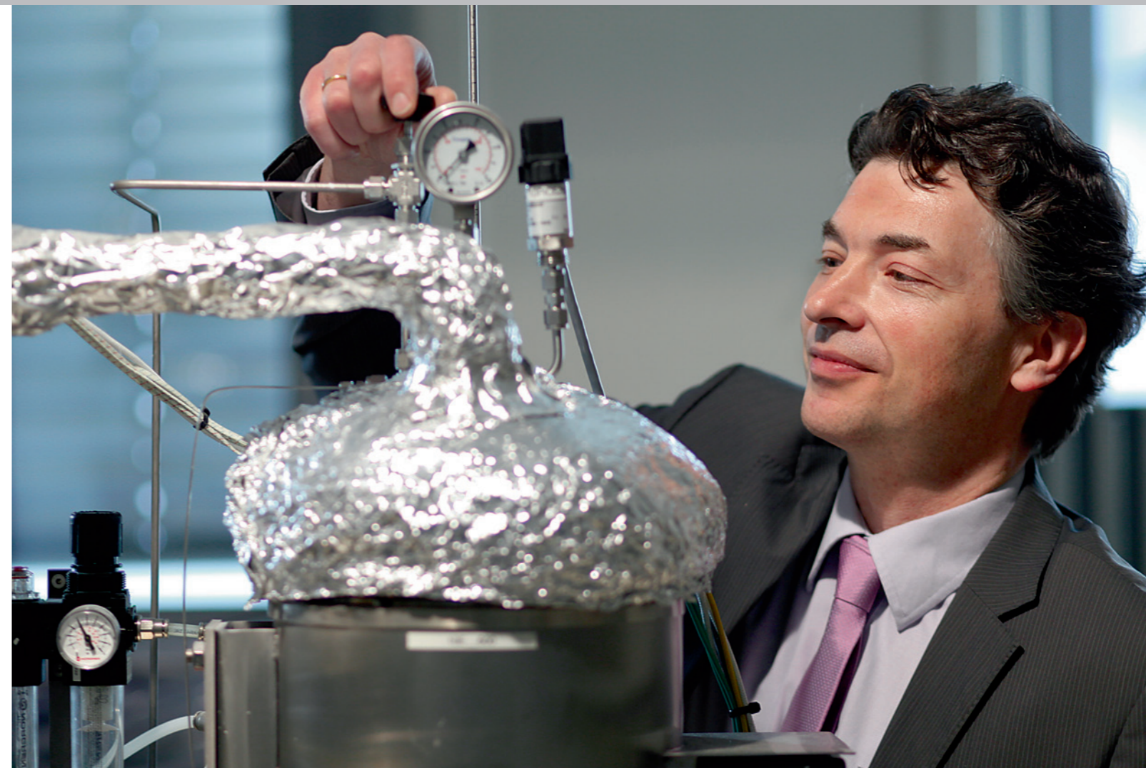
Revolution unter der Alufolie: In einem kochtopfgroßen Spezialbehälter produziert Peter Stemmermann „Celitement“ – einen Zement, der die Bauindustrie mächtig aufmischen wird. Denn seine Herstellung verschlingt weit weniger Rohstoffe und belastet die Atmosphäre nur mit halb soviel klimaschädlichem Kohlendioxid wie die Produktion des bislang gebräuchlichen Portlandzements.
