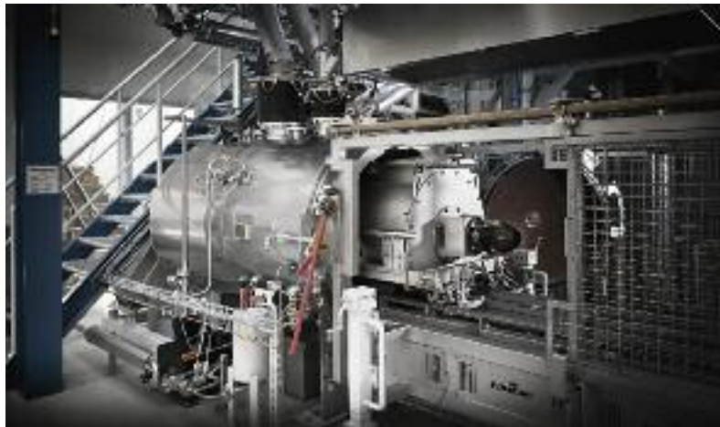
Die Pilotanlage produziert „Celitement“ ein neues klima- und ressourcenschonendes hydraulisches Bindemittel.
