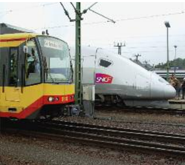
Eine von vielen Innovationen „Made in Karlsruhe“: Die Karlsruher Zweissystemwagen fahren auch auf den Gleisanlagen der Deutschen Bahn. Foto: VBK
